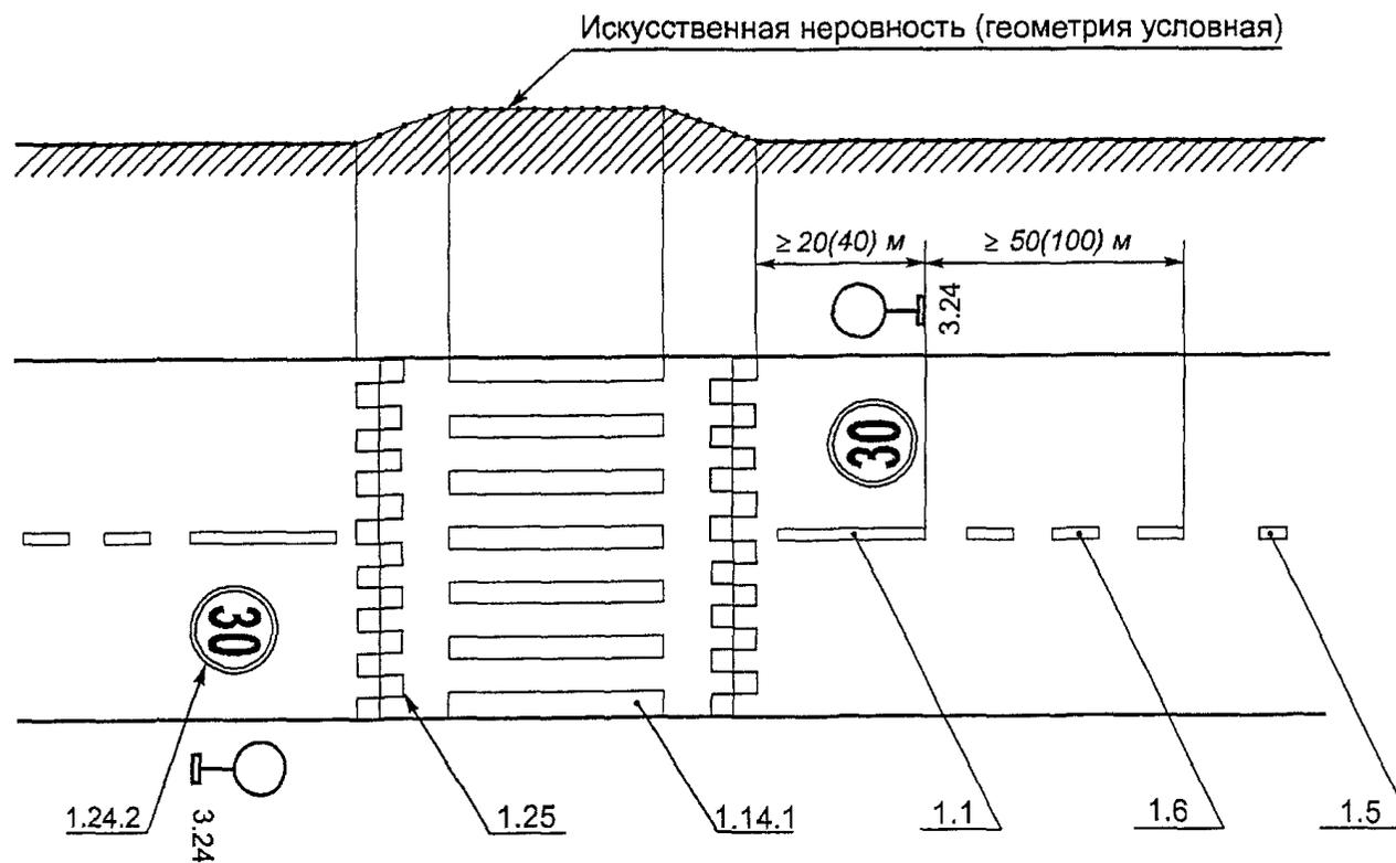
Рисунок В.19. Пример нанесения разметки [1.25](#)
