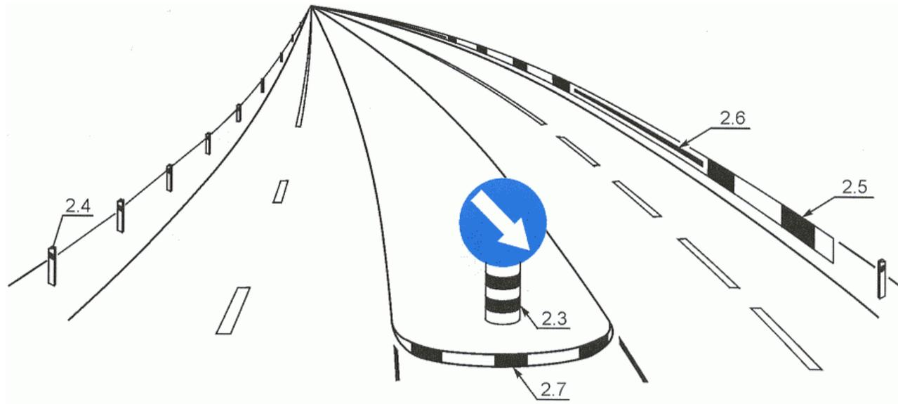
Рисунок В.22. Пример нанесения разметки 2.3 - 2.7
