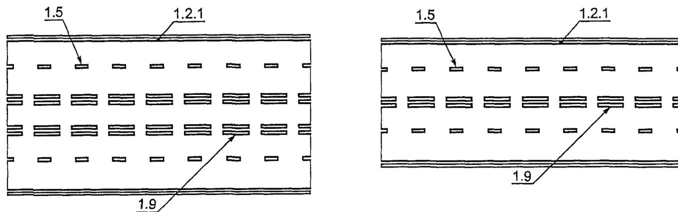
Рисунок В.16. Примеры нанесения разметки 1.9
