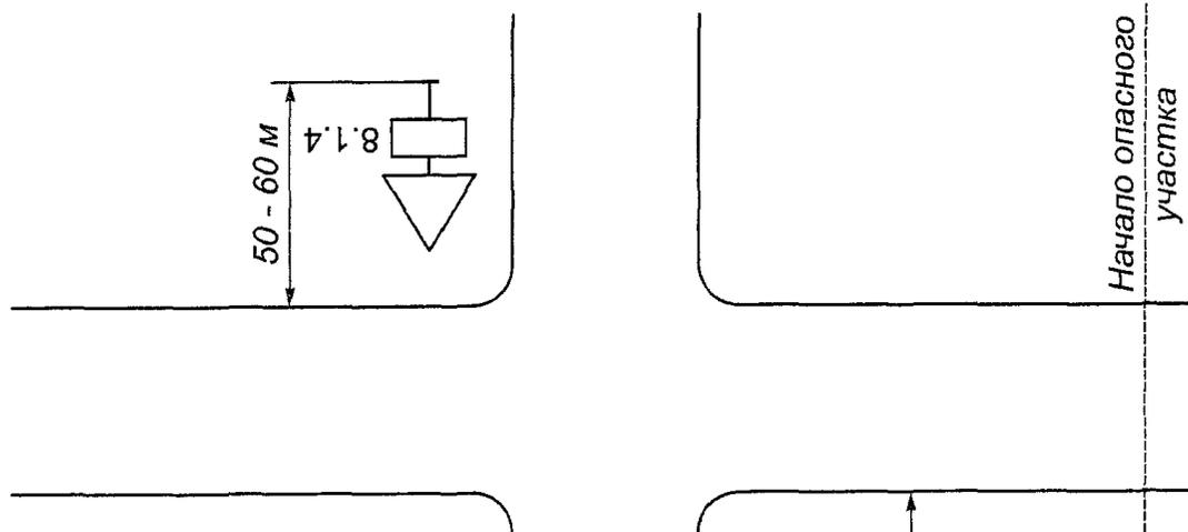
Рисунок В.2. Установка предупреждающих знаков:
