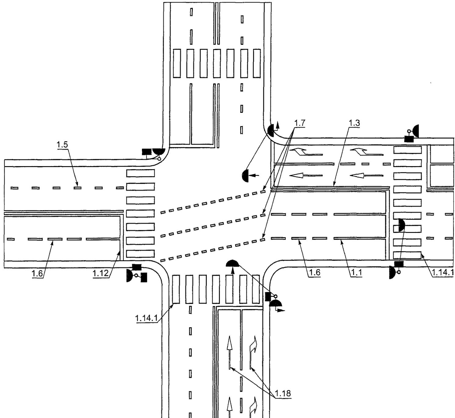
Рисунок В.9. Пример нанесения разметки
