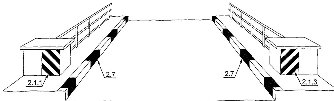
Рисунок В.21. Пример нанесения разметки 2.1.1, 2.1.3 и 2.7
