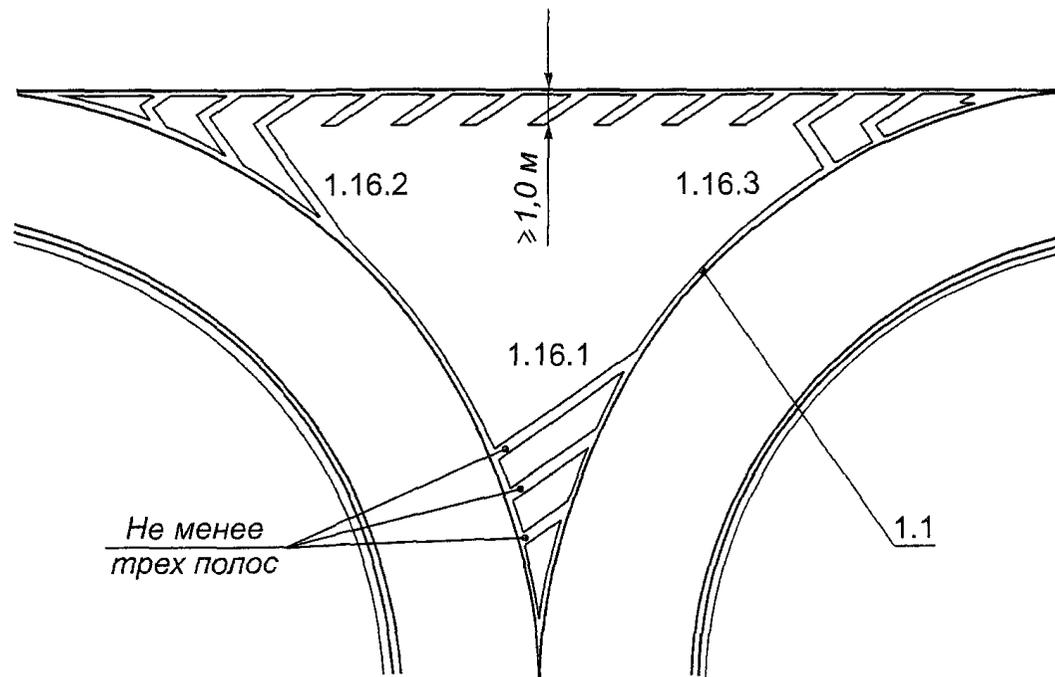
Рисунок В.12. Пример нанесения разметки 1.16.1 - 1.16.3
