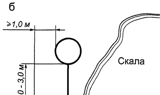
Рисунок В.1. Типовое размещение знаков
