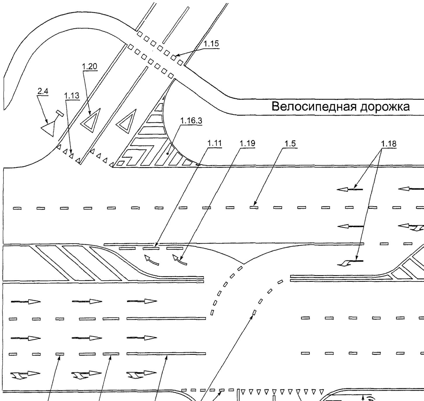
Рисунок В.10. Пример нанесения разметки канализированного пересечения
